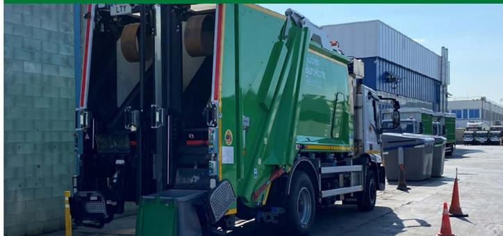
Recolector compactador bi-compartimentado de carga trasera de reducidas dimensiones sobre chasis eléctrico híbrido.
